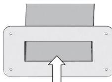
Fädeln Sie die Anschlusskabel von unten durch die Säule nach oben durch die Kabelöffnung
