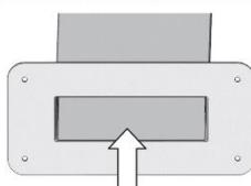
Enfilez les câbles de raccordement dans la colonne par le bas jusqu'à l'ouverture du haut.
