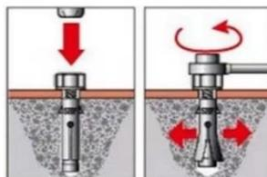
Hämmern Sie die beiliegenden Dübel so, dass sie bündig mit dem Boden abschließen.
