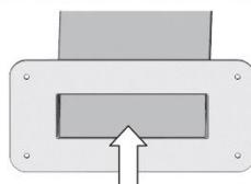
Enrosque los cables de conexión desde la parte inferior a través de la columna hacia arriba a través de la abertura del cable
