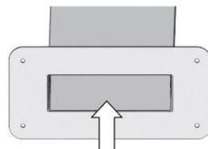
Infilare i cavi di collegamento dal basso attraverso la colonna verso l'alto attraverso l'apertura del cavo
