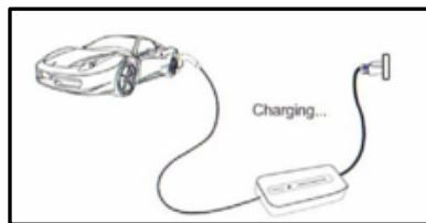
**Fin d' utilisation :** Débranchez le pistolet de charge, puis débranchez l' alimentation et couvrez le pistolet de
