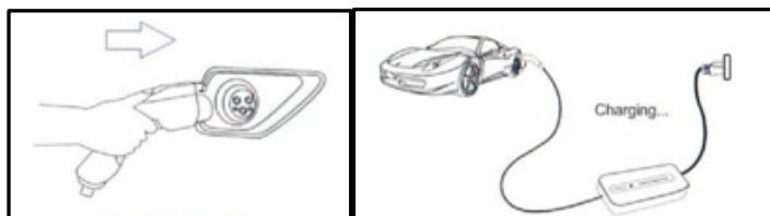
**Ende der Verwendung:** Ziehen Sie den Netzstecker aus der Steckdose, trennen Sie die Stromversorgung und decken Sie die Ladepistole mit ihrer Kappe ab.
